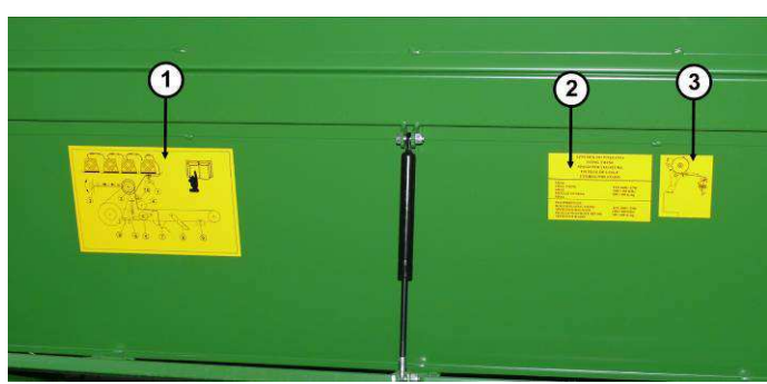
Рисунок 29 Предупредительные пиктограммы и информационные наклейки, находящиеся спереди пресс-подборщика на поднятом верхнем переднем кожухе
