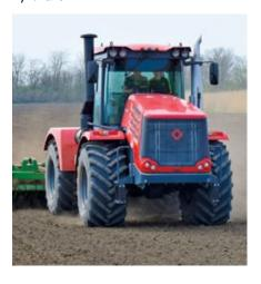
«Кировец» – самый мощный российский трактор. Вес машин – от 14 до 19 тонн. Для того чтобы увеличить их тяговые характеристики, сократить нагрузку на почву, завод рекомендует использование комплекта для сдваивания колес. Его применение уменьшает давление на грунт до 40%.
