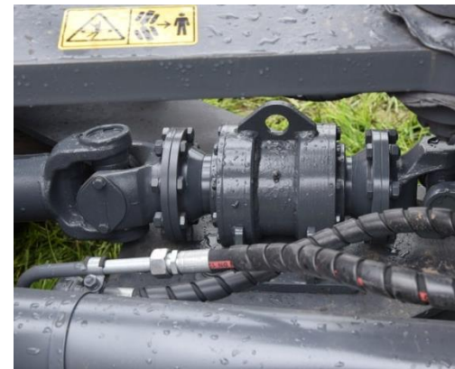
Промежуточная опора (промопора)
