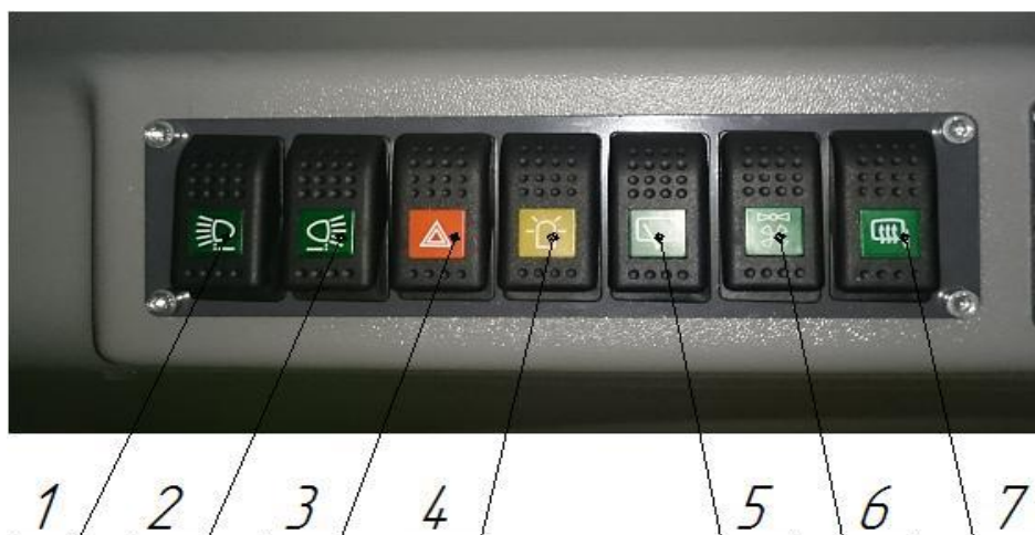
Рис.42. Панель потолочных переключателей
