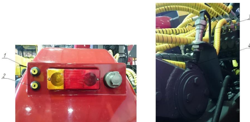
Рис.28. Управление ЗНУ выносными кнопками и установка позиционного датчика
