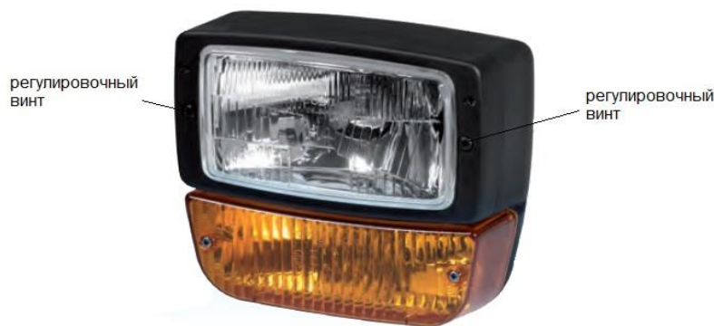
Рис.47. Регулировка головной фары
