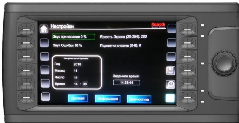
Рис.33. Настройки параметров дисплея
