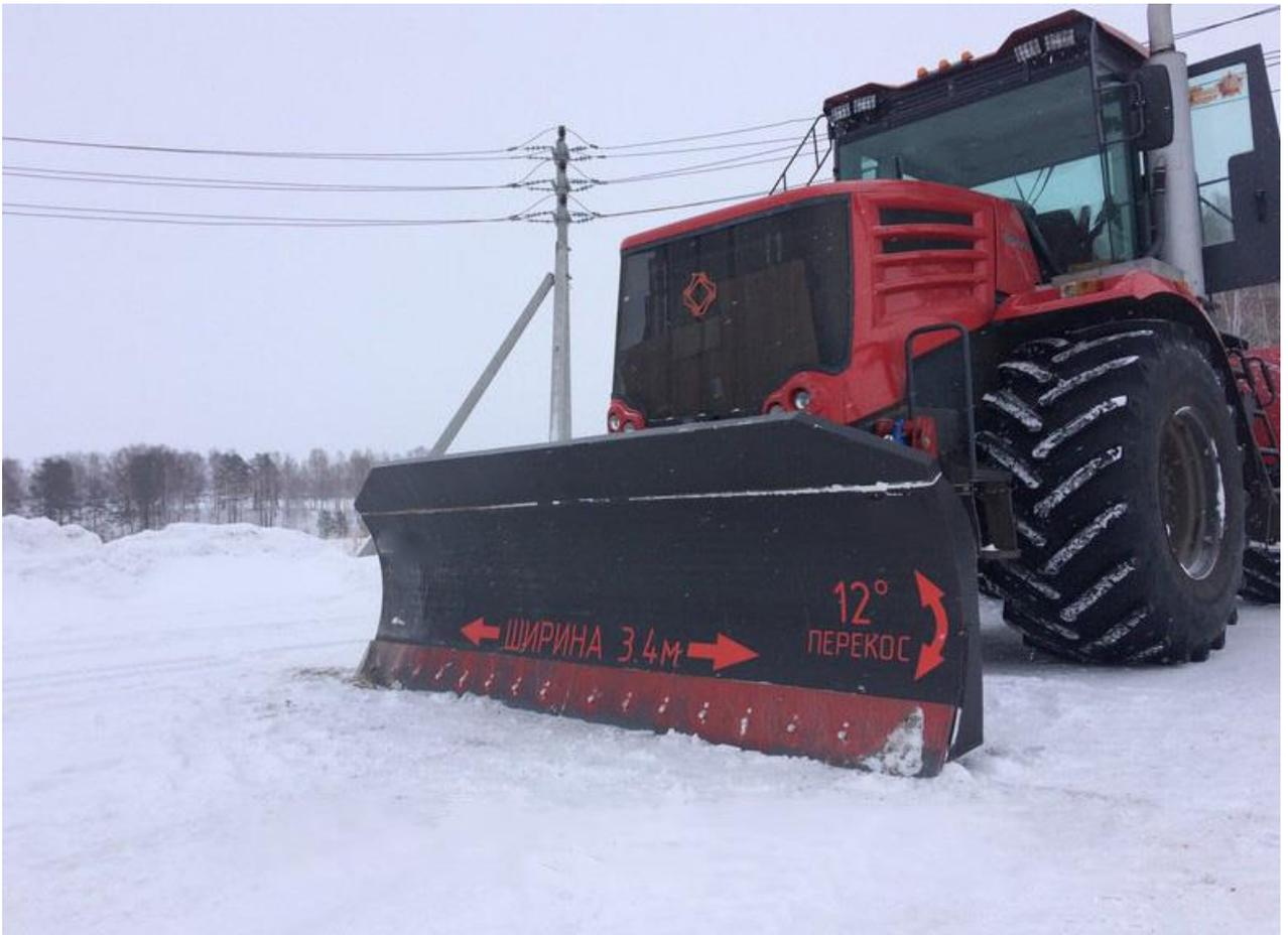
Отвал бульдозерный с системой перекоса. Монтируется на переднюю фронтальную часть трактора КИРОВЕЦ К-744Р. Использует штатную гидравлику трактора.
