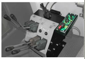
В качестве **олции** доступна система позиционного регулирования навесного устройства (ЕНR). На навесное устройство монтируются специальные датчики, а в гидрораспределитель устанавливается клапан (секция) с электрогидравлическим управлением вместо механического.
