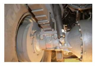
Каждый механизатор, поработавший на «Кировце», обязательно отмечает его особую плавность хода. Рессорная подвеска подмоторного моста — вот что дает такой замечательный эффект. Для многих зарубежных аналогов подрессоренный мост недоступен или является дорогостоящей опцией, а для «Кировца» серии К-744Р это базовое оснащение.
