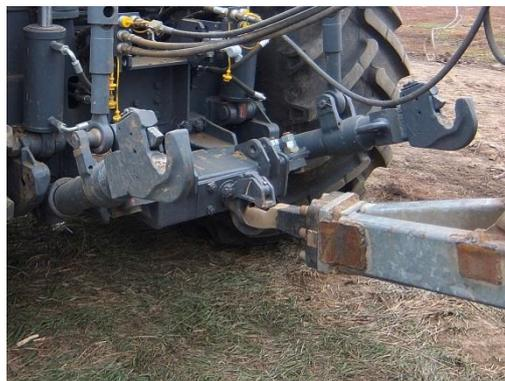
На нижних тягах навесного устройства трактора устанавливается тягово-сцепное устройство (гидрокрюк), обеспечивающее жесткую сцепку с прицепами.
