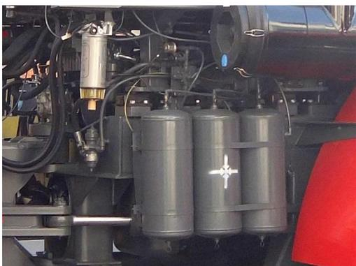
Три ресивера пневматической системы трактора находятся с правой стороны по ходу движения трактора под кабиной
