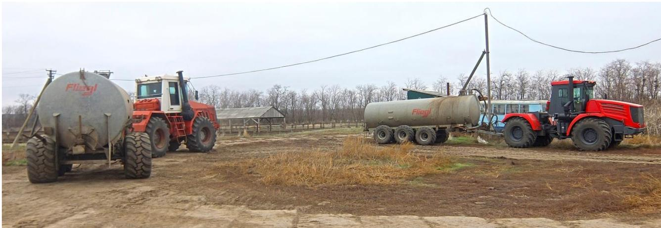
Тракторы «Кировец» оснащаются эффективной пневматической тормозной системой, поэтому успешно используются на транспортных работах с тяжелыми прицепами (общей массой до 36 тонн).
