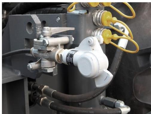
На задней полураме расположен вывод контура пневмосистемы для подключения тормозов прицепа
