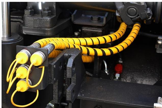
Гидролинии с быстросоединяемыми разрывными устройствами (муфтами) для подключения внешнего оборудования выведены на заднюю полураму. Рукава высокого давления (РВД) имеют дополнительную защиту.
