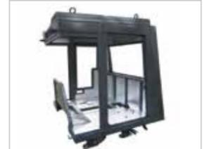
▶ Встроенный каркас безопасности кабины
