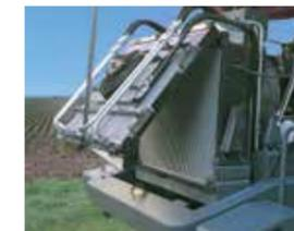
▶ Блок охлаждения с охлаждающим масляным радиатором
