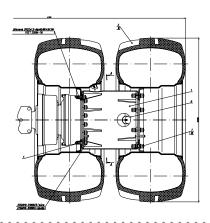
Для тракторов КИРОВЕЦ серии К-744Р разработана новая усиленная система сдваивания колес. Ключевое отличие нового комплекта сдваивания — использование жестко закрепленной на ступице вместе с внутренним колесом проставки-барабана, на которую установлено наружное колесо.
