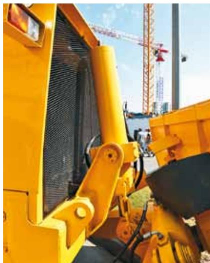
Управление рабочим оборудованием осуществляется гидроцилиндрами
