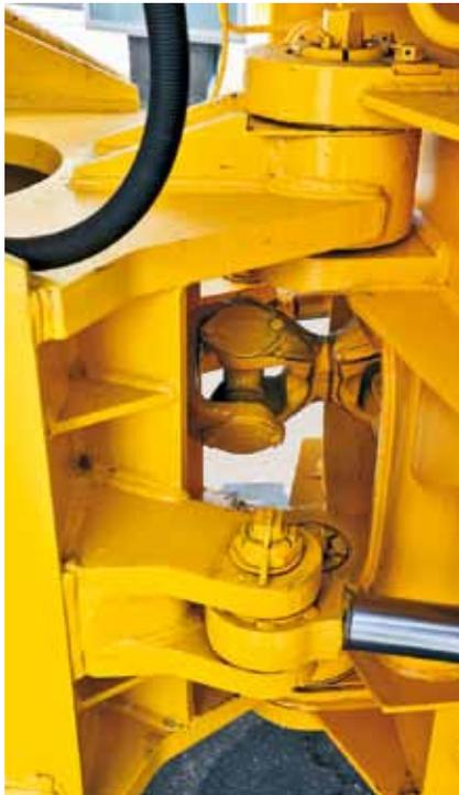
Центральные шарниры имеют механизм компенсации зазора
