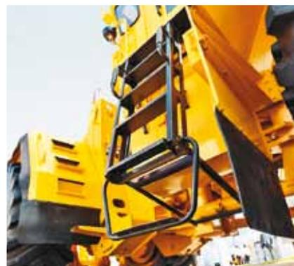
Лестница для входа в кабину оборудована двумя поручнями
