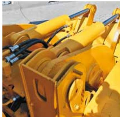
Два гидравлических цилиндра в тяжелых условиях надежнее одного
