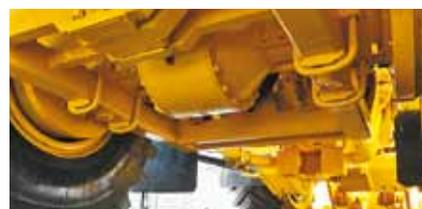
**Подмоторный мост собственного производства с планетарными редукторами**
