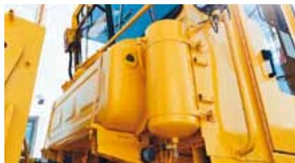
Стальной топливный бак и ресиверы расположены за кабиной
