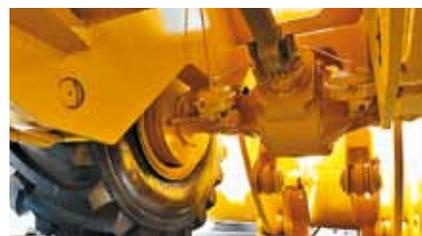
**Отключаемый передний (грузовой) мост позволяет сберечь агрегаты**
