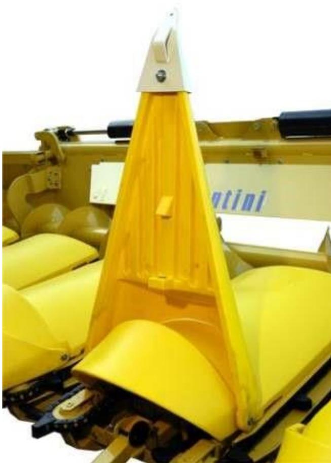
На жатках с цельной рамой возможно перевести делители в транспортное положение. Транспортировка и хранение в этом случае становится более удобным. На складных моделях так делать нельзя.
