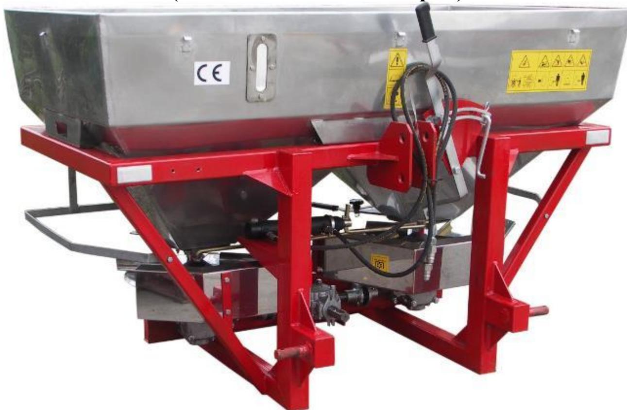
Разбрасыватели **РУМ** предназначены для поверхностного рассеивания гранулированных минеральных удобрений на пахотных полях с уклоном до 12°. Навешивается на заднее трехточечное навесное устройство трактора. Привод от ВОМа трактора через карданно-телескопический вал.
