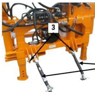
Рис. 25. Система подвески KWT 3 – Точки монтажа на трехточечной системе подвески трактора
