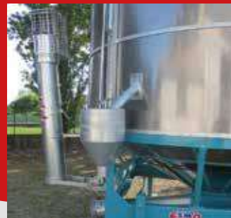
Циклон системы очистки
