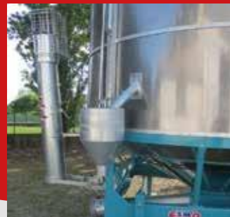
Циклон системы очистки
