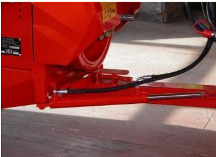
**Гидравлическое смещение дышла** позволяет оператору быстро перейти из рабочего положения в транспортное не выходя из кабины трактора.
