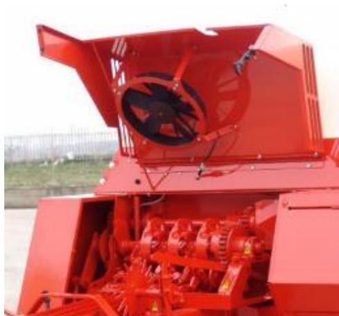
**Вентилятор для очистки узловязального оборудования** сокращает перерывы для очистки и смазки узловязального оборудования, продлевая срок службы машины.
