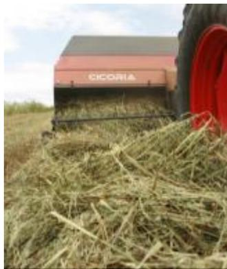
**Высокая производительность.** Широкое окно для загрузки прессовальной камеры пресс-подборщиков Sicoria позволяет вместить большие объемы соломы и др. продуктов в камеру. Это позволяет достичь высочайшей производительности и сделать максимальное количество тюков в час.
