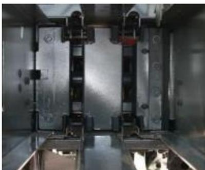
**Тяжелые и плотные тюки.** Длинный ход поршня, 75 см при 90 ударов в минуту, обеспечивает максимальную мощность прессования и одинаковую плотность тюков, а также высочайшую (в своем классе машин) производительность. Масса и плотность тюков регулируется посредством механизма контроля плотности в четырех направлениях.
