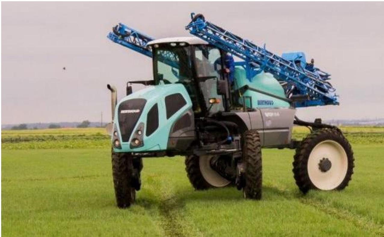
**Уникальный насос ОМЕГА производительностью 550л/мин при 3Бар с возможностью внесения КАС и ЖКУ
