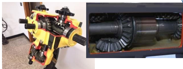
2. Редуктора с системой защиты
