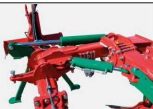
Гидравлическая регулировка рабочей ширины первого корпуса - ArcoAgro
